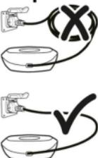
El cable de alimentación debe estar totalmente desenrollado antes de conectarse a una toma eléctrica.
