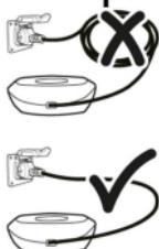
Le câble d'alimentation sera toujours totalement déroulé avant d'être branché à une prise électrique.
