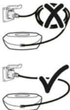
Srotolare sempre completamente il cavo di alimentazione prima di collegarlo a una presa elettrica.
